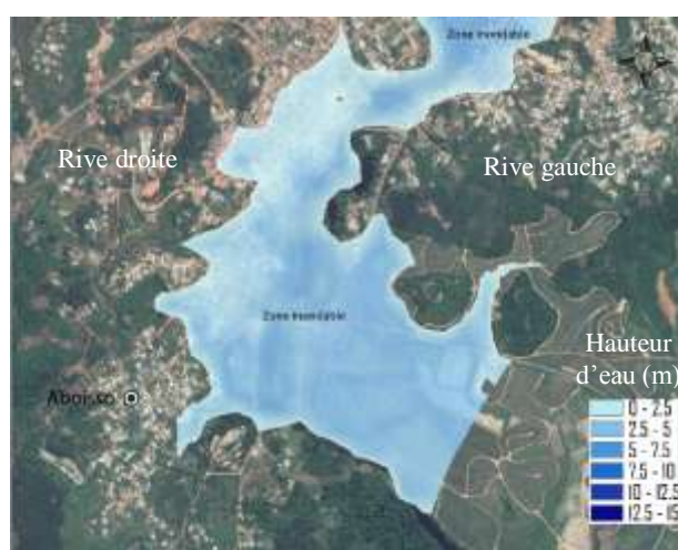
Figure 6 : Zone inondable au sud d'Aboisso, hauteurs d'eau
