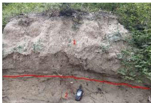
Photo 7 : Sol hydromorphe sablo-argileux (1 : horizon sablo-argileux, 2 : horizon limono-argileux)
