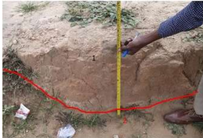
Photo 6 : Sol ferrallitique argilo-sableux de couleur rouge-brun (1 : horizon argilo-sableux, 2 : horizon argilo-limoneux)
