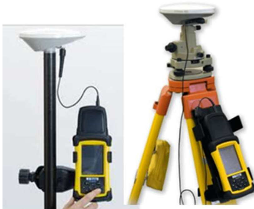
Figure 2 : L'appareil DGPS Trimble R3 utilisé pour la topographie terrestre
