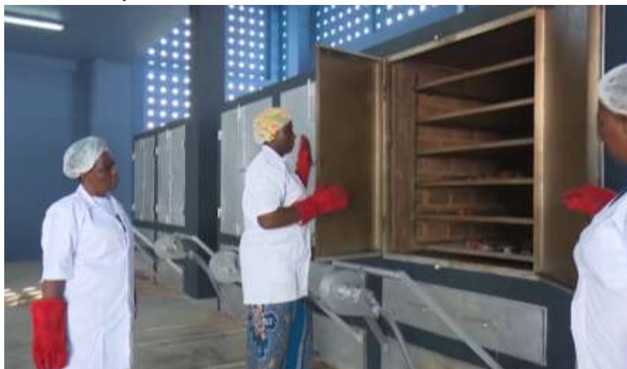
Photo 3: Le fumage de poisson au four FTT-Thiaroye de type Altona au débarcadère de Locodjro en 2020
